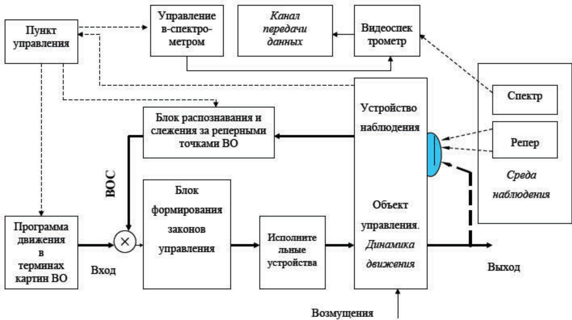
Рис. 8.2. Структурная схема реализации принципа визуальной обратной связи при управлении БПЛА гиперспектрального зондирования
